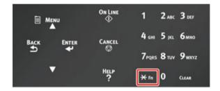
2 Enter «1», «0», «0» using the numeric keypad, check [100] is displayed on the display screen, and press the «ENTER» button.
